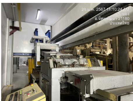
ภาพที่ 2.2-42 การติดตั้งเครื่อง Cutter ตัวใหม่
